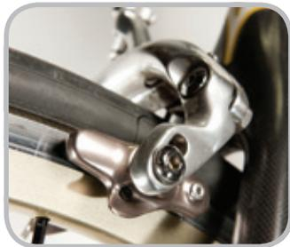
La pastillas de frenos cristalizadas, endurecidas, sucias y desalineadas causan pérdida de frenado y molestos ruidos. Mantén la superficie de tus pastillas de freno limpias usando una lija para retirar cualquier residuo adherido. Limpia e inspecciona tus pastillas de freno cada mes.
